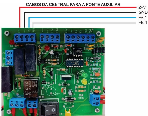
FONTE DIGITAL DA CENTRAL DE ALARME GF-250
